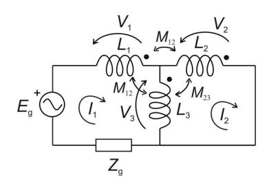
$$\begin{cases} E_g = V_1 + V_3 + Z_g I_1 \\ 0 = V_2 - V_3 \end{cases}$$
