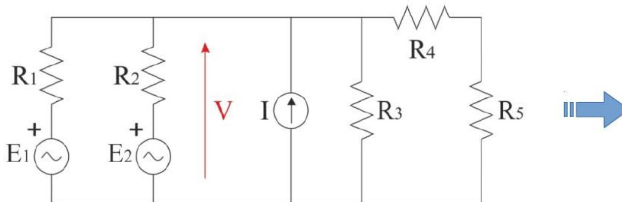
$$E_1 = 8V.; E_2 = 16V.; I = 10mA.; R_1 = 4k\Omega; R_2 = 4k\Omega; R_3 = 4k\Omega; R_4 = 2k\Omega; R_5 = 2k\Omega$$
