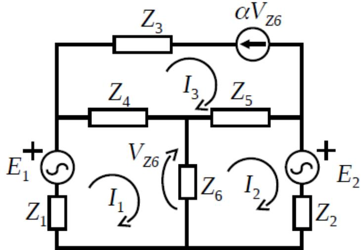
$$\left\{ \begin{array}{l} E_1 = Z_1 I_1 + Z_4(I_1 - I_3) + Z_6(I_1 - I_2) \\ -E_2 = Z_2 I_2 + Z_6(I_2 - I_1) + Z_5(I_2 - I_3) \\ \alpha V_{Z6} = -I_3 \\ V_{Z6} = Z_6(I_1 - I_2) \end{array} \right.$$
