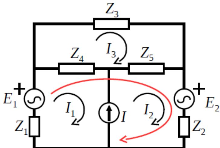
$$\left\{ \begin{array}{l} E_1 - E_2 = Z_1 I_1 + Z_4(I_1 - I_3) + Z_5(I_2 - I_3) + Z_2 I_2 \\ 0 = Z_3 I_3 + Z_5(I_3 - I_2) + Z_4(I_3 - I_1) \\ I = I_2 - I_1 \end{array} \right.$$
